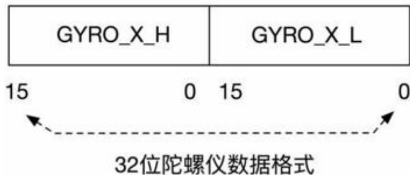
图 20 SPI32 位数据还原示意图
