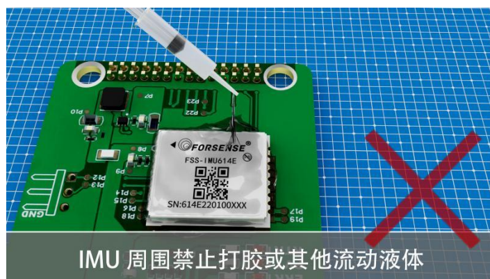
图 24 安装错误示意图
